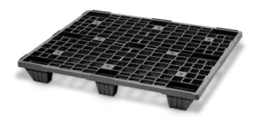
El perfil en «Z» de la cubierta del Nest i1.1 confiere al palet una resistencia a la flexión especialmente elevada y con ello, un alto grado de resistencia y capacidad de carga. El diseño especial de los pies del palet le permite ser totalmente encajable y ahorrar espacio cuando se transporta en vacío. Además, su reducida tara de 6 kg contribuye al ahorro en los costes de transporte.
